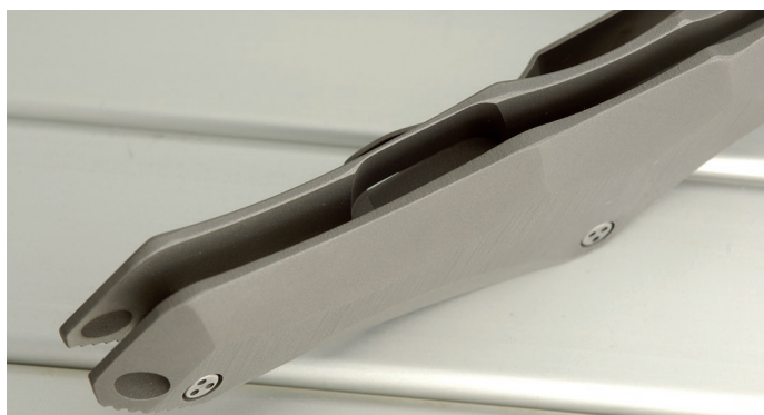
Ausgedünnt: Am Ansatz des Liners wird so viel Material weggefräst, dass man ihn ohne große Mühe bewegen kann.
