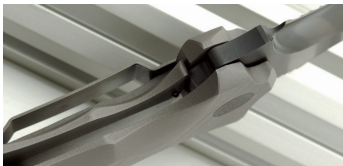
Hier wackelt nichts: Der bewegliche Liner, der die Klinge arretiert, ist fünf Millimeter stark – so wie die selbsttragenden Griffschalen.
