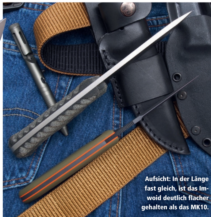
Starker Flatschliff: Das Imvoid bewährt sich eher bei feinen und präzisen Schnitten sehr gut.
